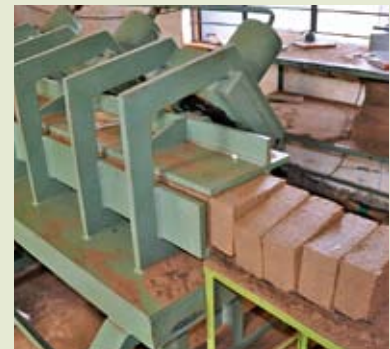
Diese Blockpresse fertigt 5-kg-Blocks.
